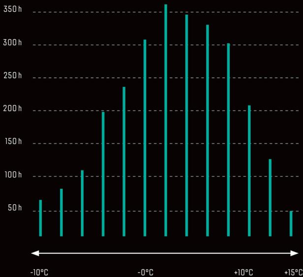
Dieser ist in der EN14825 geregelt und wird in einem aufwendigen Prüfverfahren in einem zertifizierten Prüfinstitut ermittelt. Dazu wird die Wärmepumpe bei verschiedenen Temperaturbereichen auf ihre Effizienz geprüft. Sowohl die Einsatzgrenze (bei -20°C), als auch die Prüfpunkte bei -10°C, -7°C, 2°C, 7°C und 12°C, werden exakt vermessen.
